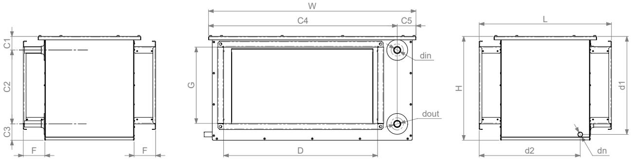
Abbildung 4.2.4. RWC Abmessungen
