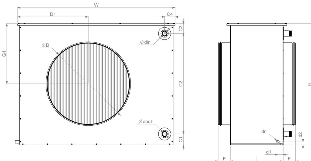
Abbildung 4.2.3. AVA DX Abmessungen
